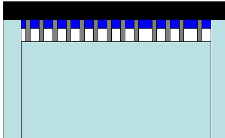
Possibilité d'introduire des grilles de protections d'évacuation d'eau pluviale
